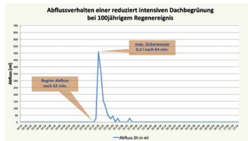
Sickerwasserabfluss einer reduziert intensiven Dachbegrünung bei einem 100-jährigen Regenereignis
