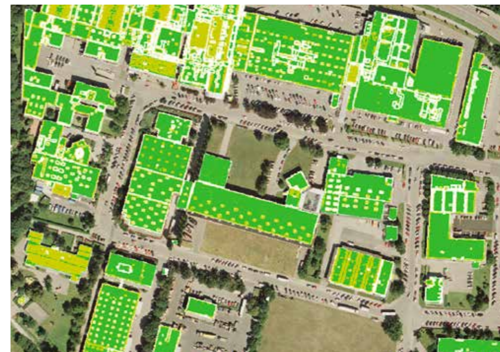
Potentiale für Ausgleichsmaßnahmen sind vorhanden: Grün eingefärbt = Anteil der begrünbaren Industrieflächdächer am Beispiel des Gewerbegebietes Auhofcenter in 1140 Wien
