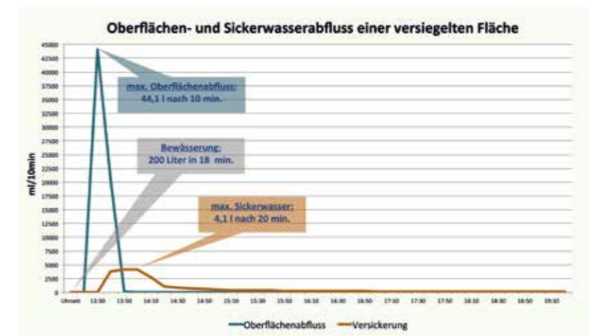
Oberflächen- und Sickerwasserabfluss einer versiegelten Fläche mit 15 m 2 bei einer Messberechnung von 200 l in 30 Minuten
