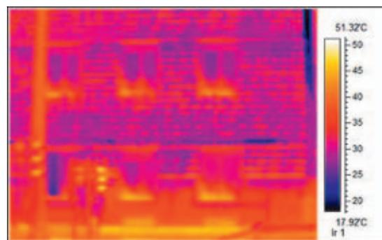
Abbildungen 8 und 9: Oberflächentemperaturen an der Südfassade eines nebenstehenden Gebäudes mit Putzfassade (Durchschnittswerte um 45° C) und der MA 48 Grünfassade (Durchschnittswerte um 30° C) im August 2011.
