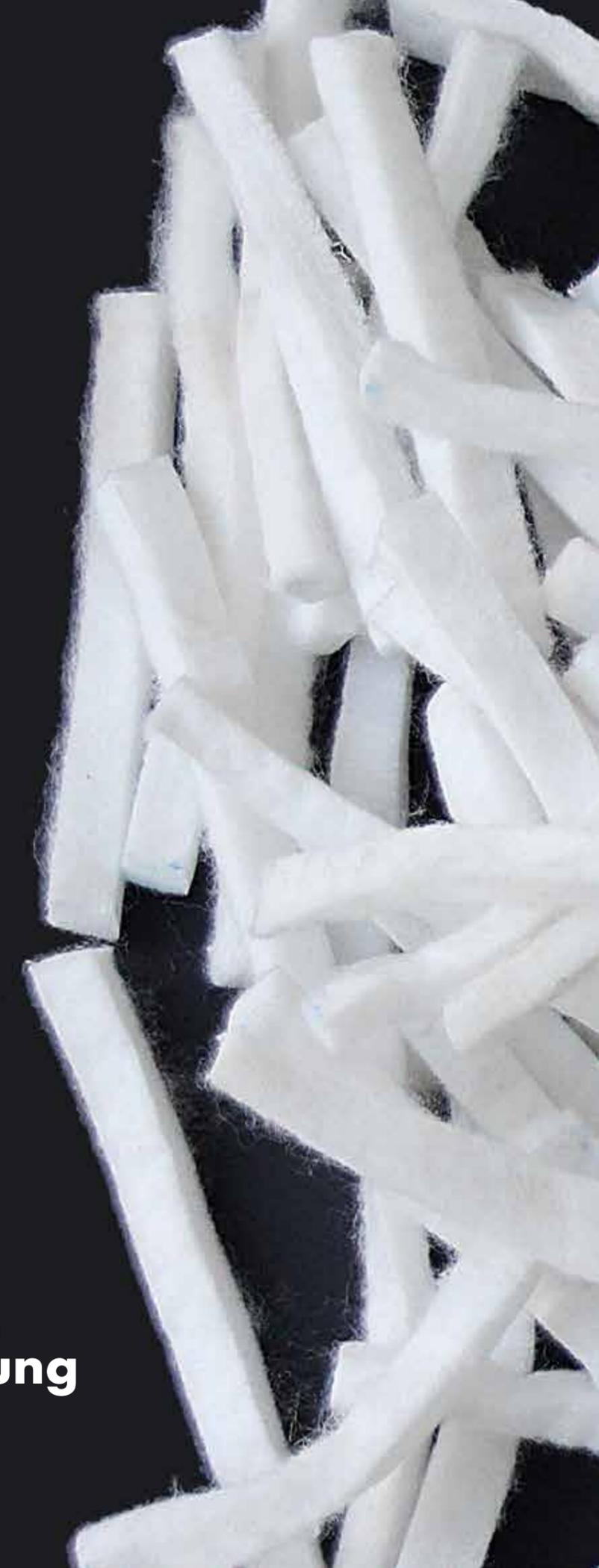
Bei **Dachbegrünungen** führt die **hohe Wasseraufnahmefähigkeit** der leichten Streifen zu einem **massiven Gewichtsvorteil** im Vergleich zu konventionellen Materialien (z.B. Tonkügelchen).
