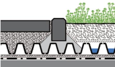
Eingesetzt als „verlorene Schalung“, bleibt die durchgängige Drainagefunktion unter beiden Belagsvarianten erhalten.
