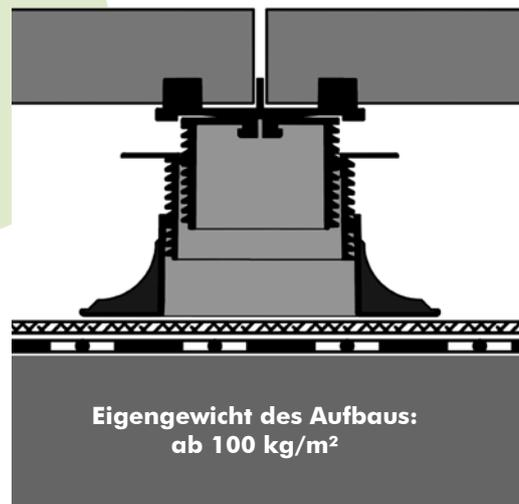
Plattenbeläge aus Beton oder Naturstein  $d \geq 4 \text{ cm}^*$  bzw. Holzbeläge
