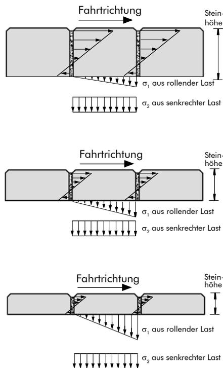
Die Kräftepfeile machen deutlich, dass der Lastabtrag bei dicken Steinen vermehrt über die Flanken erfolgt, wogegen dünne Steine, die über eine geringe Flankenhöhe (Stützfläche) verfügen, Verkehrslasten vermehrt durch eine Kantenpressung auf der Unterseite der Steine abtragen, Deformationen des Pflasterbettes sind die Folge.
