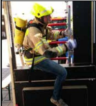
Laut verschiedenen Regelwerken müssen „geeignete Gebäudeöffnungen“ zum Anleitern durch die Feuerwehr für die Fremdrettung eine Größe im Bereich von 80 cm x 120 cm aufweisen.
