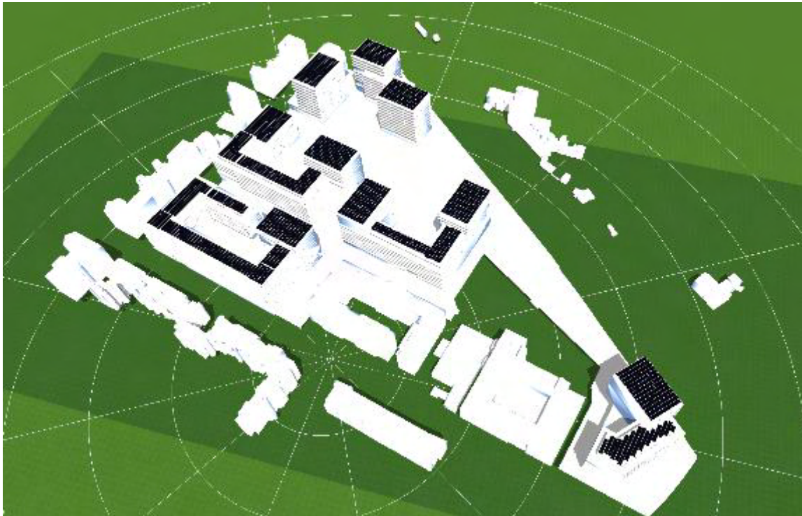
Abbildung 87: Ost-West-Ausrichtung des Simulationsdachs für den ursprünglichen Masterplan
