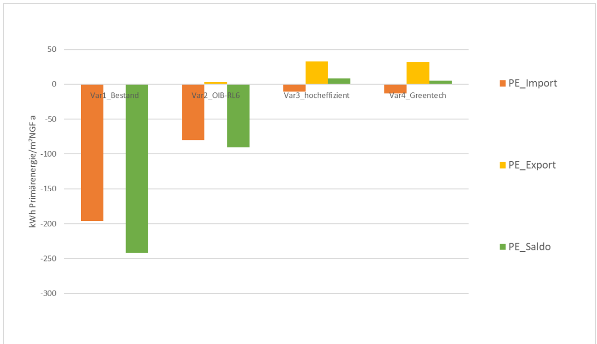
Abbildung 71: Akkumulierte monatliche Bilanzen des erneuerbaren und nicht erneuerbaren Primärenergiebedarfs für den Betrieb des Gebäudes und die motorisierte private Alltagsmobilität. Primärenergiefluss in das System wird negativ, Exporte positiv dargestellt.
