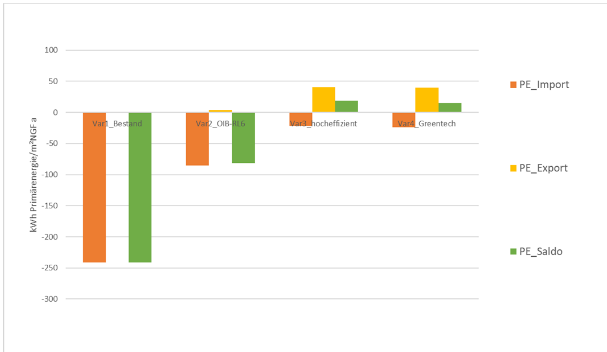
Abbildung 68: Akkumulierte monatliche Bilanzen des erneuerbaren und nicht erneuerbaren Primärenergiebedarfs für den Betrieb des Gebäudes. Primärenergiefluss in das System wird negativ, Exporte positiv dargestellt.
