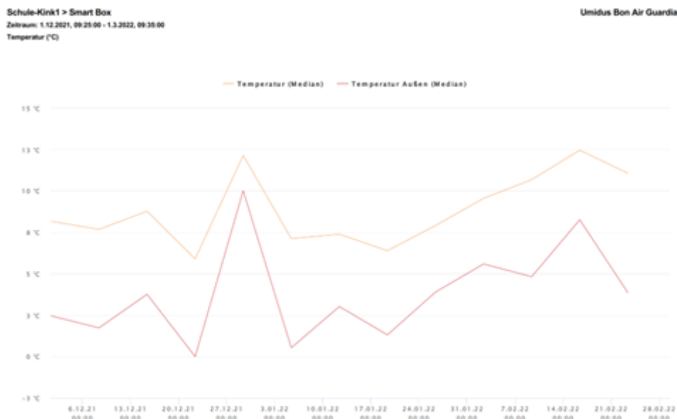
Abbildung 32: Jahresverlauf der Außentemperatur und der Innentemperatur in der Aula
