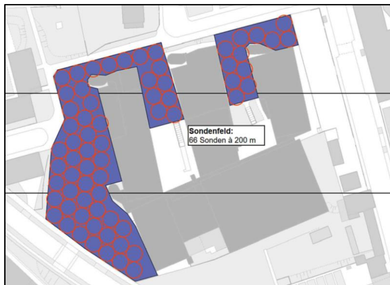
Abbildung 59: beispielhafte Darstellung Erdwärmesonden-Auslegung (Obergasser, 2022)
