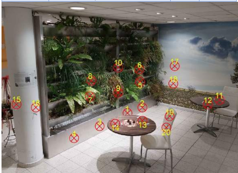
Abbildung 13 Beprobungspunkte für die Bestimmung der Schimmelsporen mit Hilfe von Abklatschtests in unmittelbarer Umgebung der vertikalen Begrünung in Tulln
