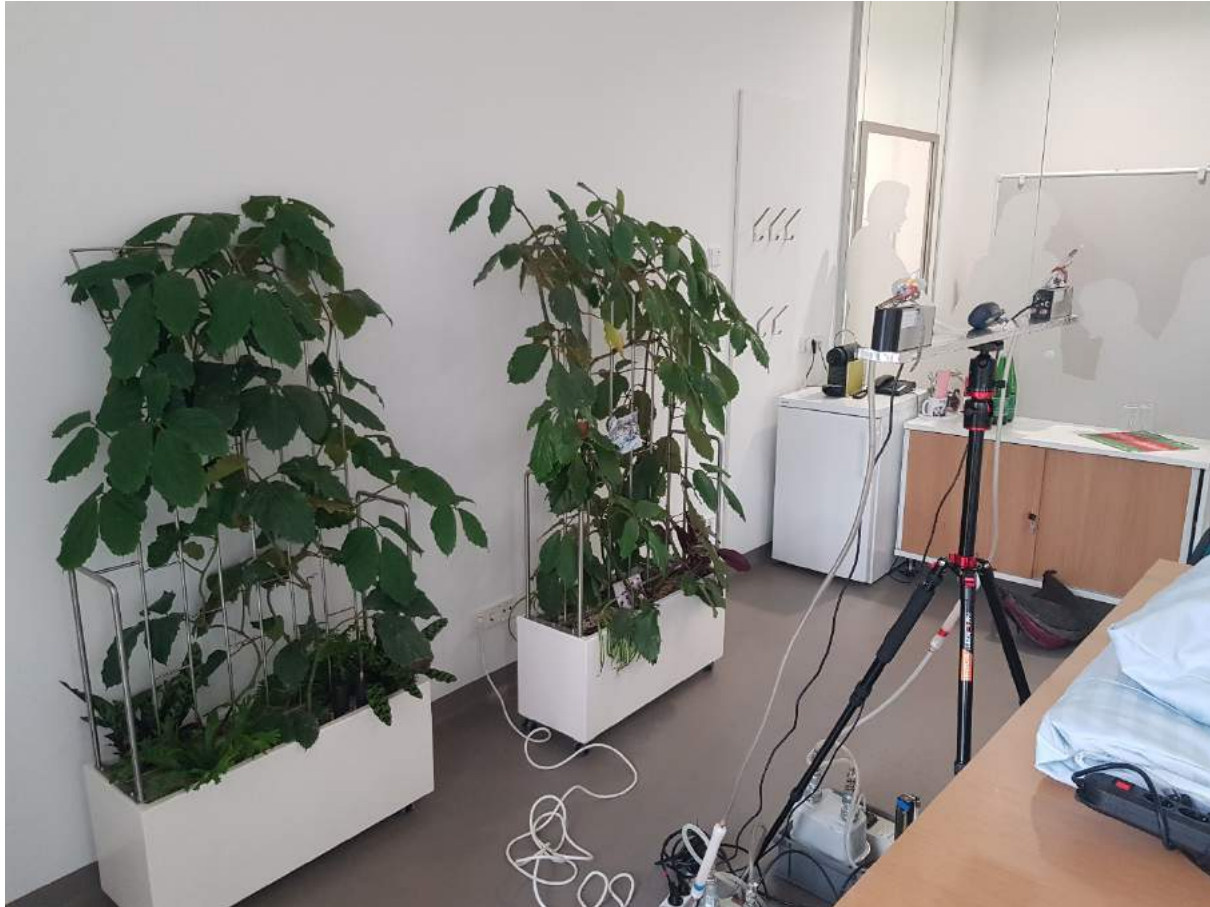
Abbildung 18: Positionierung der troggebundenen Begrünung im Rahmen der Messreihen des Expositionsszenarios im Besprechungszimmer des PBZ Wolkersdorf
