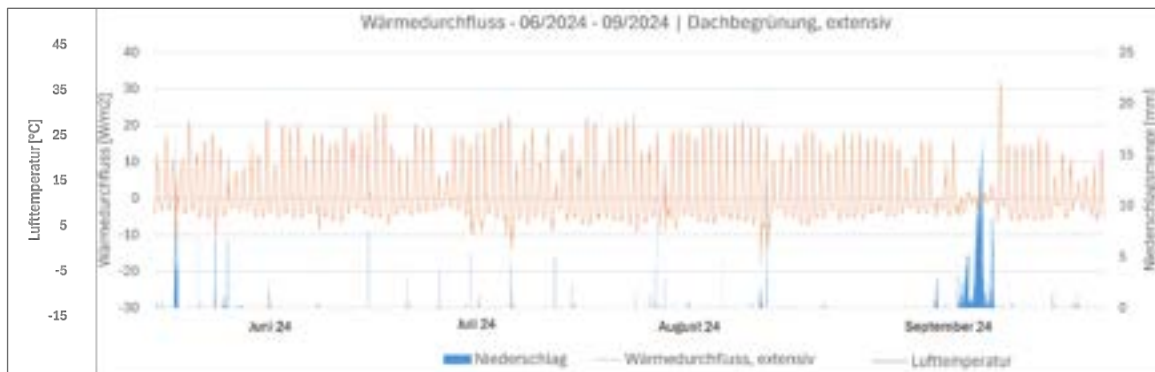
Abbildung 118: Wärmedurchfluss im Substrat Juni - September 2024, extensive Dachbegrünung [HTL St. Pölten, Niederösterreich] (©IBLB).
